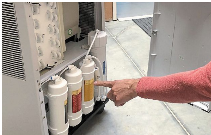
L'eau est potabilisée par un circuit de filtration et agrémentée par l'Institut Pasteur, souligne François Broquaire.
